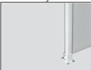
Haltepfosten mit angeschweißter Bodenplatte
