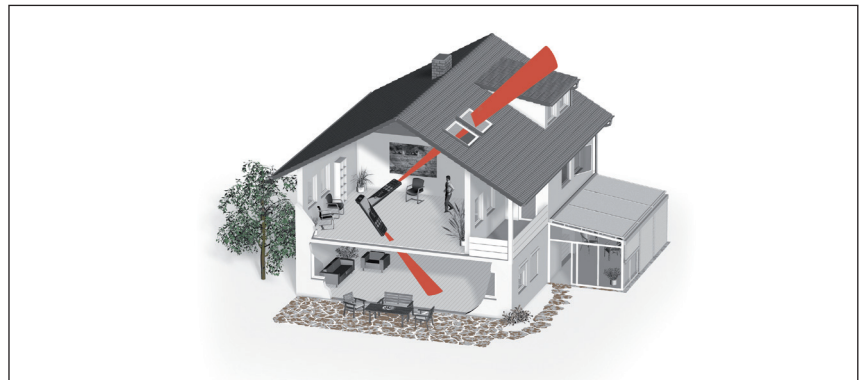
Abb. 29 Ausbreitung von Funkwellen in Gebäuden
