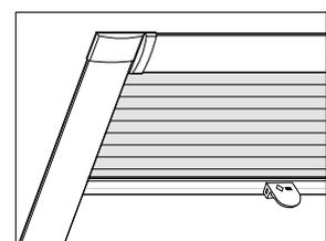
**Montage:** Befestigung durch Dachfensterträger. Die Seitenführungsschienen werden seitlich an den Rahmen geschraubt. Weiteres Zubehör siehe Seite 81-83.
