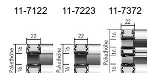
**Bedienung:** Öffnen und Schliessen mittels Bedienschienen. Schienen arretieren an jeder gewünschten Position. Für schwer erreichbare Anlagen ist auf Wunsch ein Bedienstab erhältlich.
