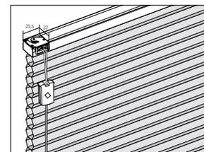
**Montage:** Deckenmontage (Standard) mit Clips. Wandmontage mit Winkel- oder Glasleistenträger für Frontmontage und Klemmträger gegen Aufpreis. Bis Breite 100 cm 2 Träger, ab Breite 101 cm 3 Träger. Träger und Zubehör siehe Seite 77-78.
