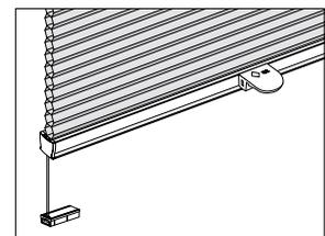
**Montage:** Deckenmontage (Standard) mit Clips. Wandmontage mit Winkel- oder Glasleistenträger für Frontmontage und Klemmträger gegen Aufpreis. Bis Breite 64 cm 2 Träger, ab Breite 65 cm 3 Träger. Träger und Zubehör siehe Seite 84-85.
