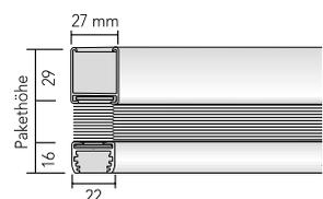
**Bedienung:** **Modell 11-8130:** Heben und Senken mittels Bedienkette. Behang arretiert automatisch. Bedienseite wahlweise links oder rechts. Bedienlänge (L) mindestens 100 cm, dann ca. 2/3 Anlagenhöhe, andere Längen auf Wunsch. Kettenhalter im Lieferumfang enthalten.
