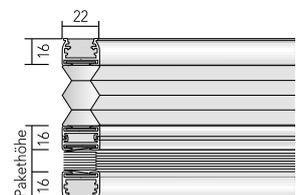
**Bedienung:** Öffnen und Schliessen mittels Bedienschiene. Schiene arretiert an jeder gewünschten Position. Nur der rechteckige Teil des Behangs kann geöffnet werden. Für schwer erreichbare Anlagen ist auf Wunsch ein Bedienstab erhältlich.
