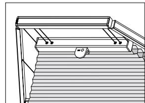
**Montage:** Deckenmontage (Standard) mit Clips. Wandmontage mit Winkelträgern gegen Aufpreis. 11 Träger pro Anlage. Montageprofil für erforderlichen Abstand zur Glasscheibe (siehe Seite 115 - Einbauempfehlungen). Träger und Zubehör siehe Seite 89.
