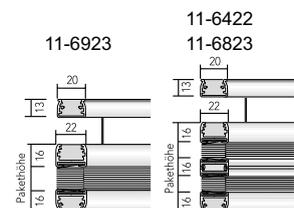
**Bedienung:** Öffnen und Schliessen mittels Bedienschiene. Schiene arretiert an jeder gewünschten Position. Für schwer erreichbare Anlagen ist auf Wunsch ein Bedienstab erhältlich.
