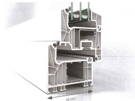
Hohe Basissicherheit: Die erhöhte Bautiefe und weit innen liegende Beschläge entziehen die Verschlusselemente dem Angriff der Einbrecher.
