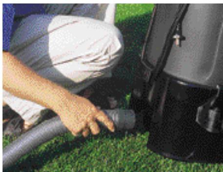
Der Ablaufschlauch wird über einen Schnellverschluss am Fuß des Schlammsaugers angebracht.
